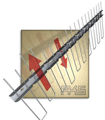
Die Spikes sind mit dem Bügel in Richtung Dachfläche zu montieren und decken eine Höhe bis 100 mm bzw. 130 mm bzw. 160 mm ab.
