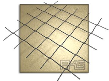
Polypropylen-Netze sind UV-stabilisiert (300 KLY), beständig bis ca. 100 °C, der Schmelzpunkt liegt bei ca. 165 °C und in folgenden Ausführungen einsetz- und lieferbar:
